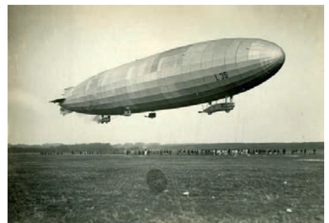
ZEPPELIN LZ-80 – германский дирижабль, толкаемый вперед шестью двигателями Maybach, развивал скорость до 103 км/ч
