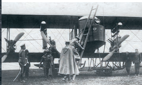
НИКОЛАЙ II инспектирует четырехмоторный биплан конструкции И. И. Сикорского «Русский витязь», построенный на Русско-Балтийском вагонном заводе (фотография 1913 года)
